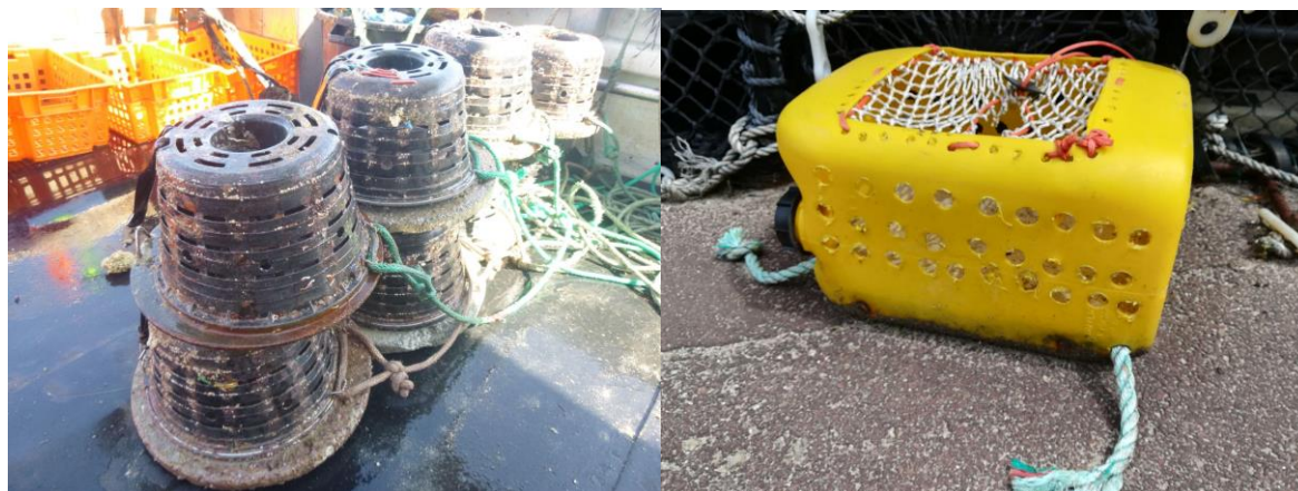
Figure 1.4 - Photographie des 2 types de casier utilisées sur la façade Manche Est - Mer du Nord pour l'exploitation du bulot ; (gauche) casier type cloche, (droite) casier artisanal fabriqué à partir de bidons (crédits photo : Laurence Hegron-Macé, SMEL)
