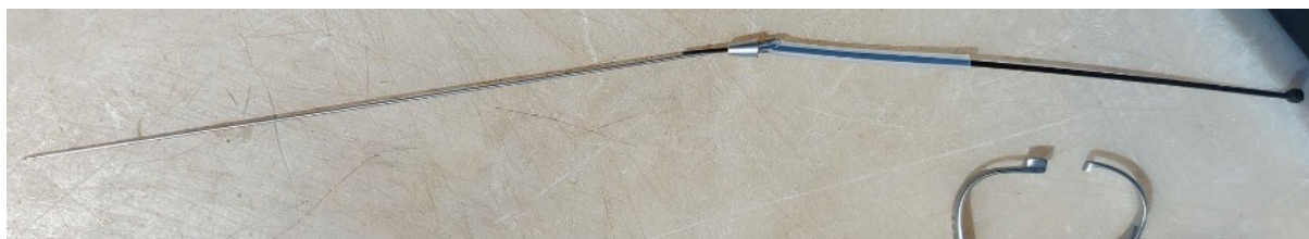
Figure 14. Gaine entourant le serre-câble en plastique permettant de fixer la marque sur la raie (©IFREMER - Tristan Rouyer))
